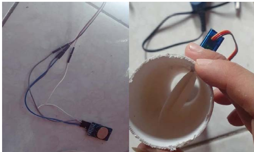
Gambar 3.9 Rangkaian Kontrol RTC DS3231 dengan Motor Servo
